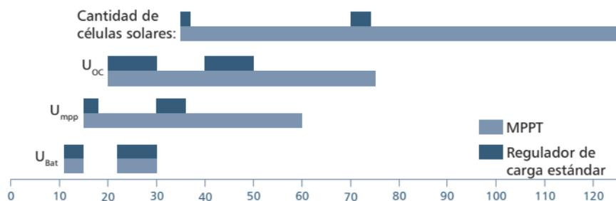
En comparación con los reguladores de carga sin MPPT, los seguidores de MPP pueden ser aplicados en un rango de módulos amplia. Con un seguidor de MPP ya no se depende de la tensión de módulo ni del tamaño del string. La tensión de módulo puede diferir mucho de la tensión de la batería.
