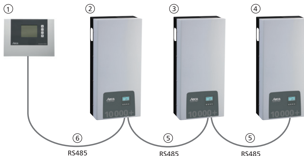
Рис. 6: Схема на полагането на кабелите, изобразена на примера на дистанционния индикатор StecaGrid Vision
