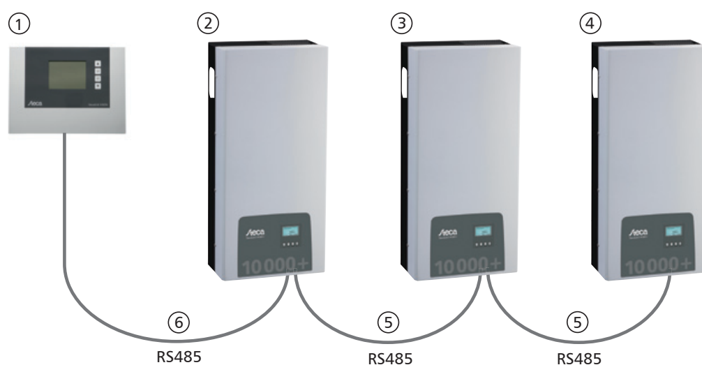
Fig. 6: Schema di cablaggio sull'esempio del display remoto StecaGrid Vision
