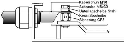
Sicherung muss unbedingt gemäss der Zeichnung montiert werden. Die Isolationsscheibe darf weder weggelassen noch durch eine Metallscheibe ersetzt werden! Der HPC 2800-12 wird ohne diese Sicherung geliefert. Das Batteriekabel für den Minuspol muss somit wie jenes für den Pluspol festgeschraubt werden. Zum Schutz muss auf dem Kabelanschluss auf der Batterie eine entsprechende Sicherung montiert werden.
