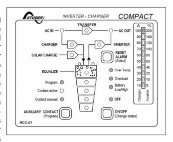
Vorgehen für die Programmierung ist im Abschnitt Programmierung beschrieben. In der Fernsteuerung sind ein weiterer Hilfskontakt und ein Steuereingang eingebaut. Diese beiden Funktionen stehen über eine Steckbuchse RJ11/4 zur Verfügung. Der Hilfskontakt ist ein Arbeitskontakt (max. 0.5A!), welcher unabhängig vom
