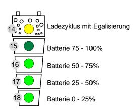
COMPACT eingebaute Messsystem berücksichtigt die Batteriespannung, den Entlade- respektive den Ladestrom sowie die Welligkeit der Spannung. Werden die Batterien und der HP-COMPACT entsprechend deren technischen Daten betrieben zeigt das System den Zustand der Batterie verlässlich an. Bei folgenden nicht abschliessend behandelten Betriebsfällen kann die Anzeige abweichen:
