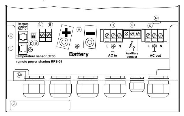
A Battery +/- Anschlussschr. (M8) für Batteriekabel (HPC 4400-24/6000-
