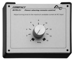
Wird zum Beispiel ein Generator mit 2000 Watt angeschlossen muss der Drehknopf auf höchstens 8,7A eingestellt werden. Diesen Wert erhält man, indem die Leistung von 2000 Watt durch 230V geteilt wird. Wenn der HP-COMPACT an eine Stromquelle angeschlossen wird die zum Beispiel mit einer 6A Sicherung geschützt ist, muss der Drehknopf auf maximal 6A eingestellt werden.
